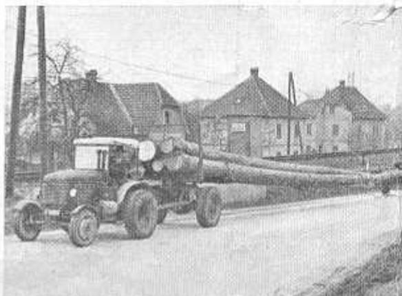
\* Der Schlepper kann nicht ohne weiteres mit der Schleppachse verwendet werden, sondern es sind dazu eine Reihe grundlegender Änderungen am Traktor erforderlich.
